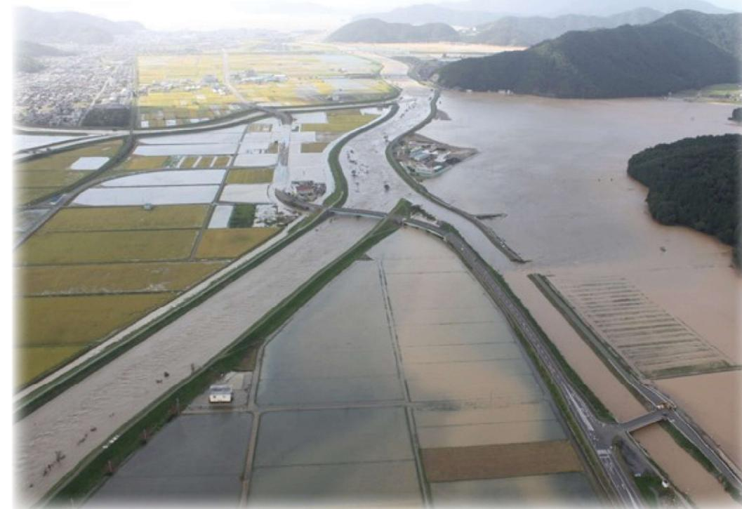
平成 25 年 9 月 16 日 台風 18 号 国富地区 野木川の堤防が決壊し浸水している様子
