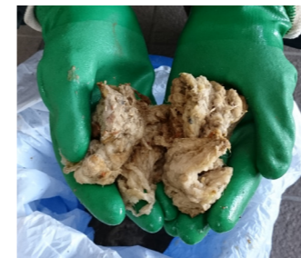
下水道で詰まった異物
