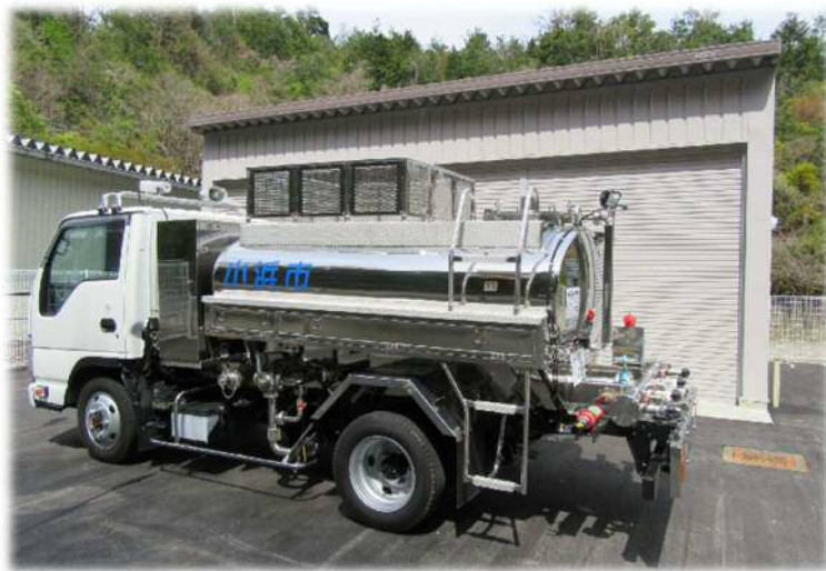
加圧給水車、応急給水資機材倉庫
