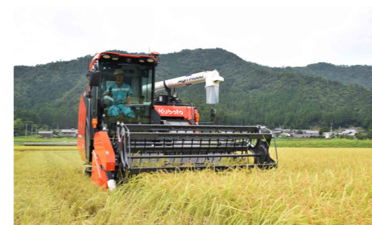
収穫作業と同時に作物の食味成分や収量を自動で測定する機能を持つコンバインでコメを収穫
