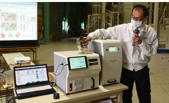
コメの成分を計測し、おいしさを数値化する「食味分析器」。作業履歴などのデータと合わせ、品質の向上・安定につなげる
