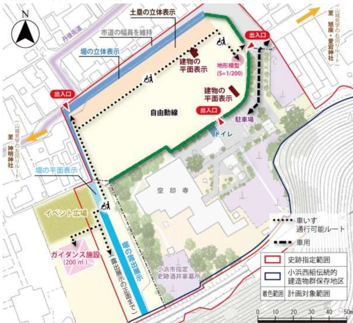
図 5-8 守護館北側・西側地区および空印寺境内地区の動線計画図
